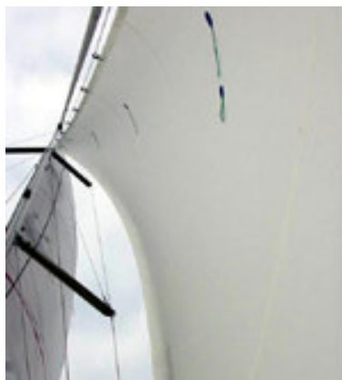
Chute qui ouvre dans les hauts
